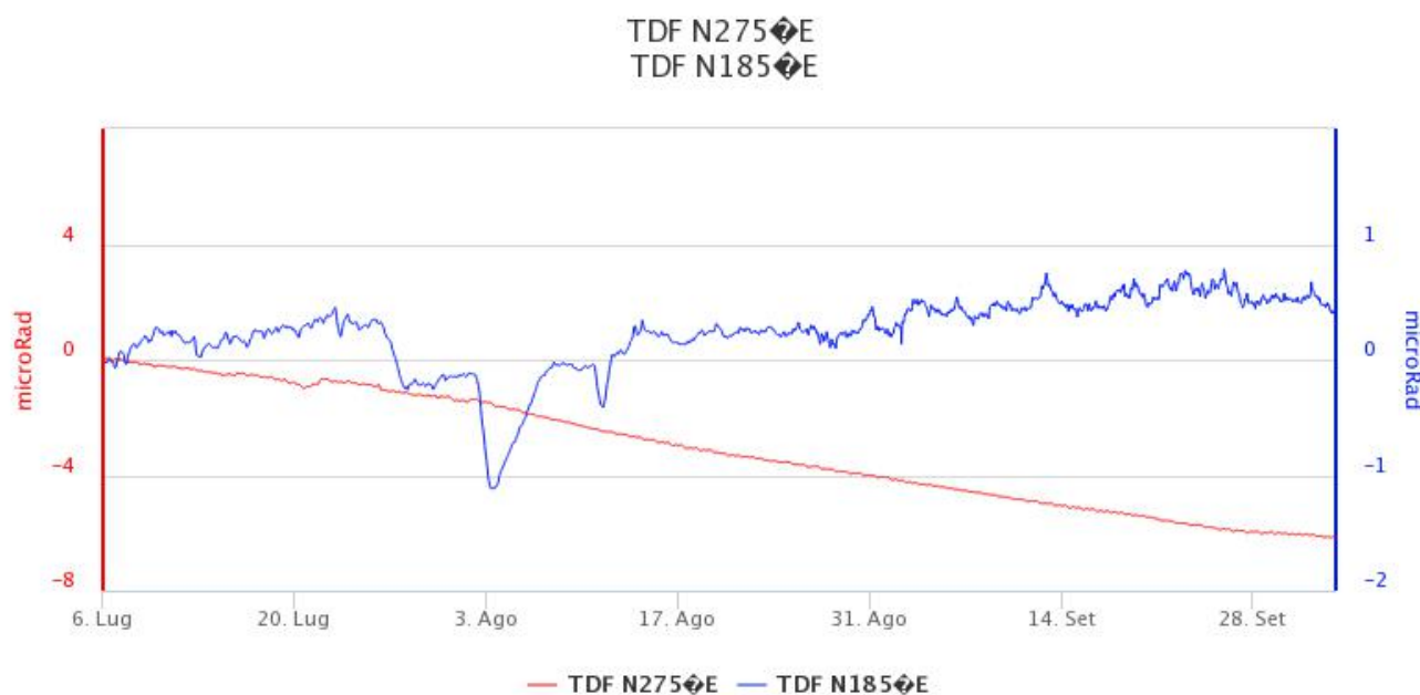
Fig. 5.2 - Serie temporali delle componenti X e Y [microRad] del tilt di Timpone del Fuoco durante gli ultimi tre mesi
