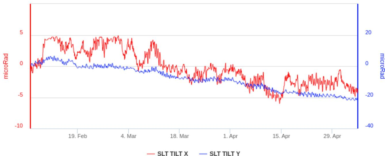
Fig. 12.1 Serie temporale delle componenti Radiale (X) e Tangenziale (Y) del clinometro della stazione SLT registrate nell'ultimo trimestre.
