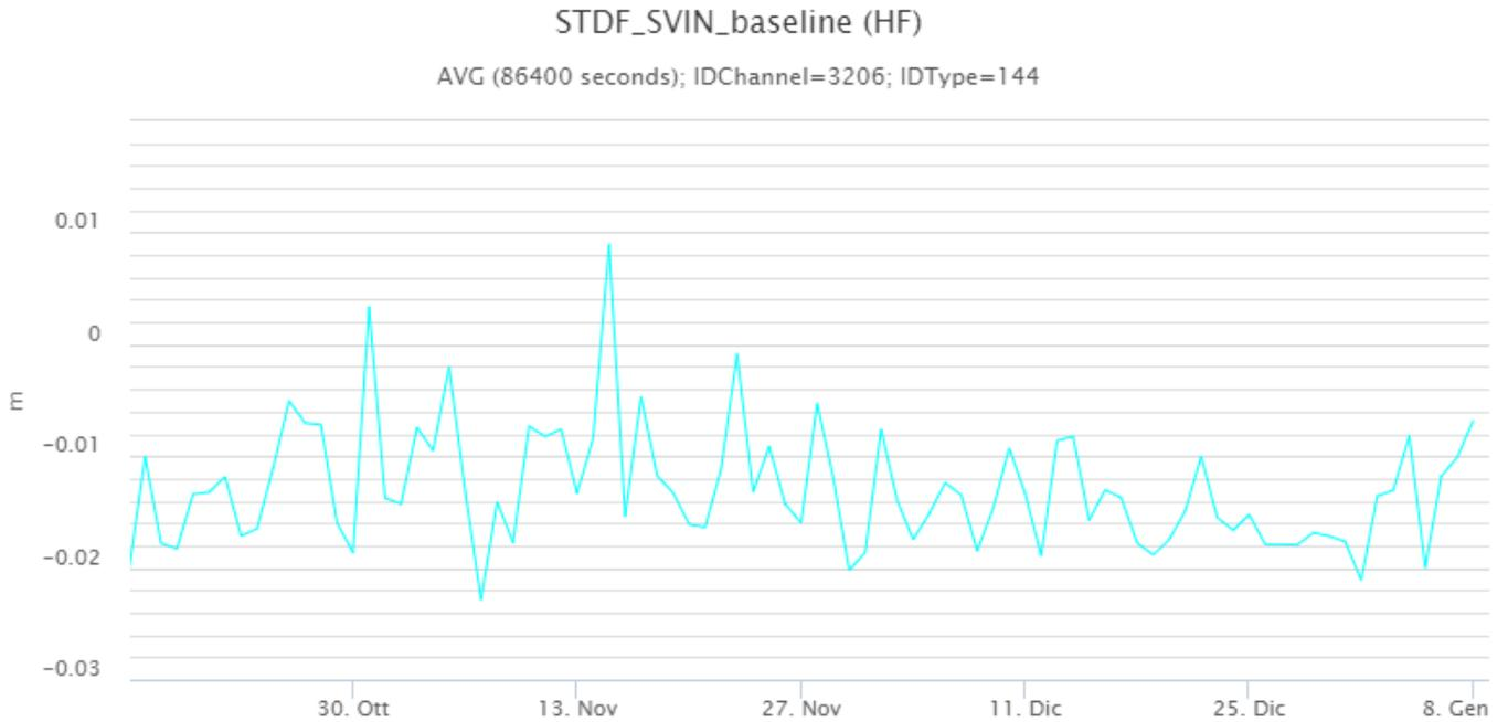
**Fig. 5.1** Serie temporale della variazione di distanza (in m) tra le stazioni GNSS di SVIN e di STDF, nel corso dell'ultimo trimestre
