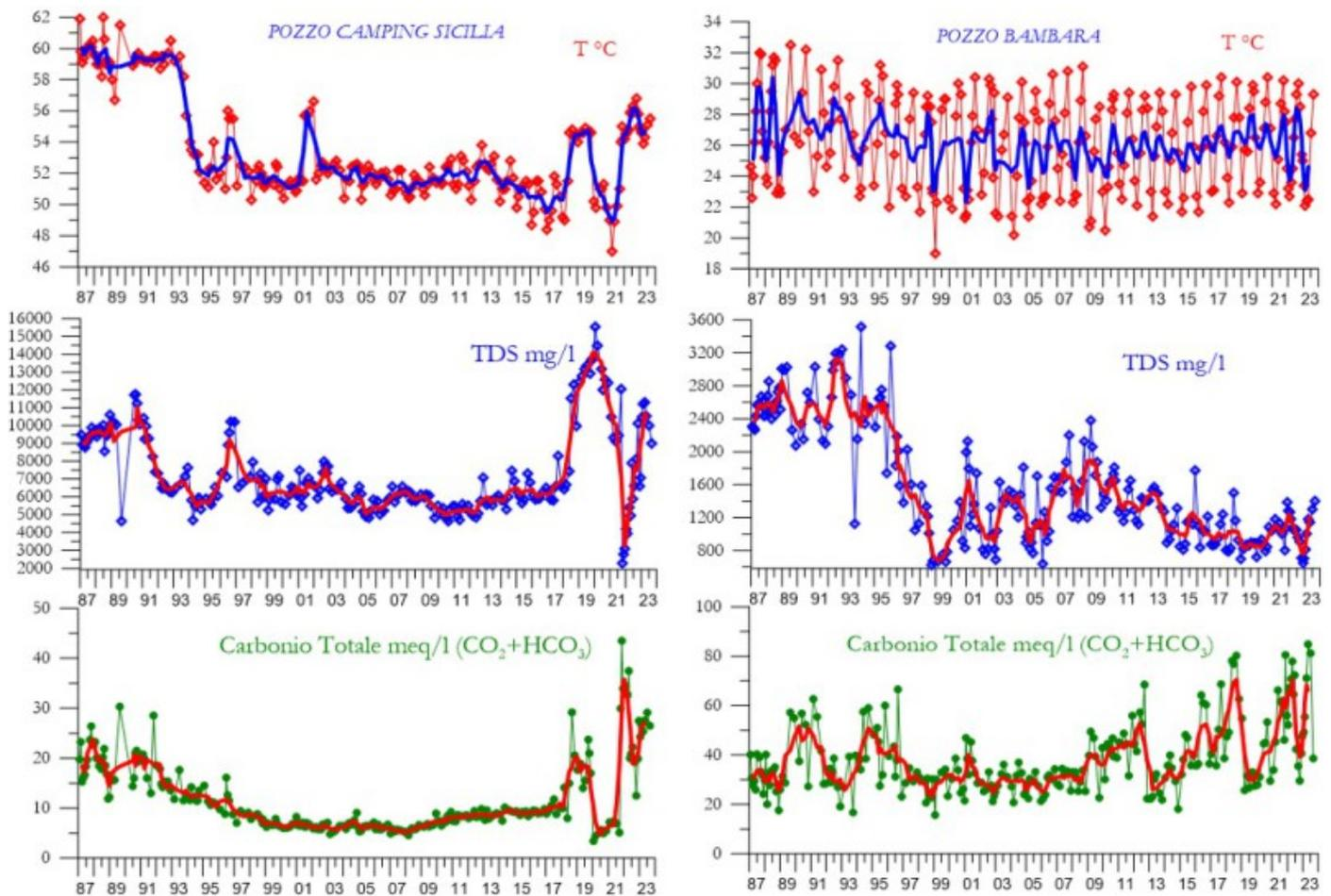
**Fig. 8.3** Record storico dei dati di temperatura, salinità e carbonio totale disciolto misurati in discreto nelle acque dei pozzi *Camping Sicilia e Bambara*.
