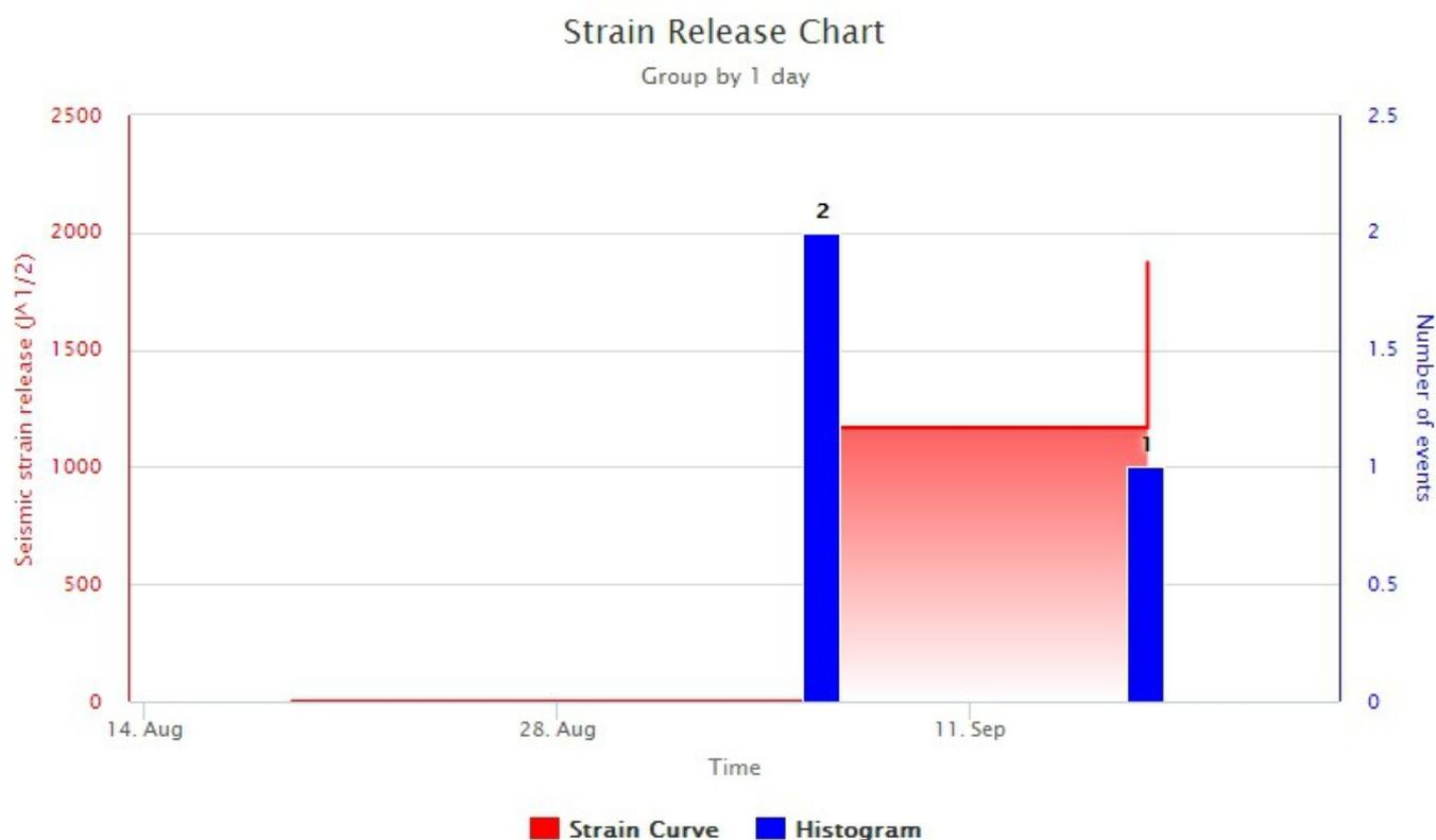
**Fig. 10.1** *Frequenza giornaliera di accadimento e curva cumulativa del rilascio di strain sismico dei terremoti con  $M_l$  maggiore o uguale a 1.0 localizzati nell'ultima settimana nell'area di Vulcano.*
