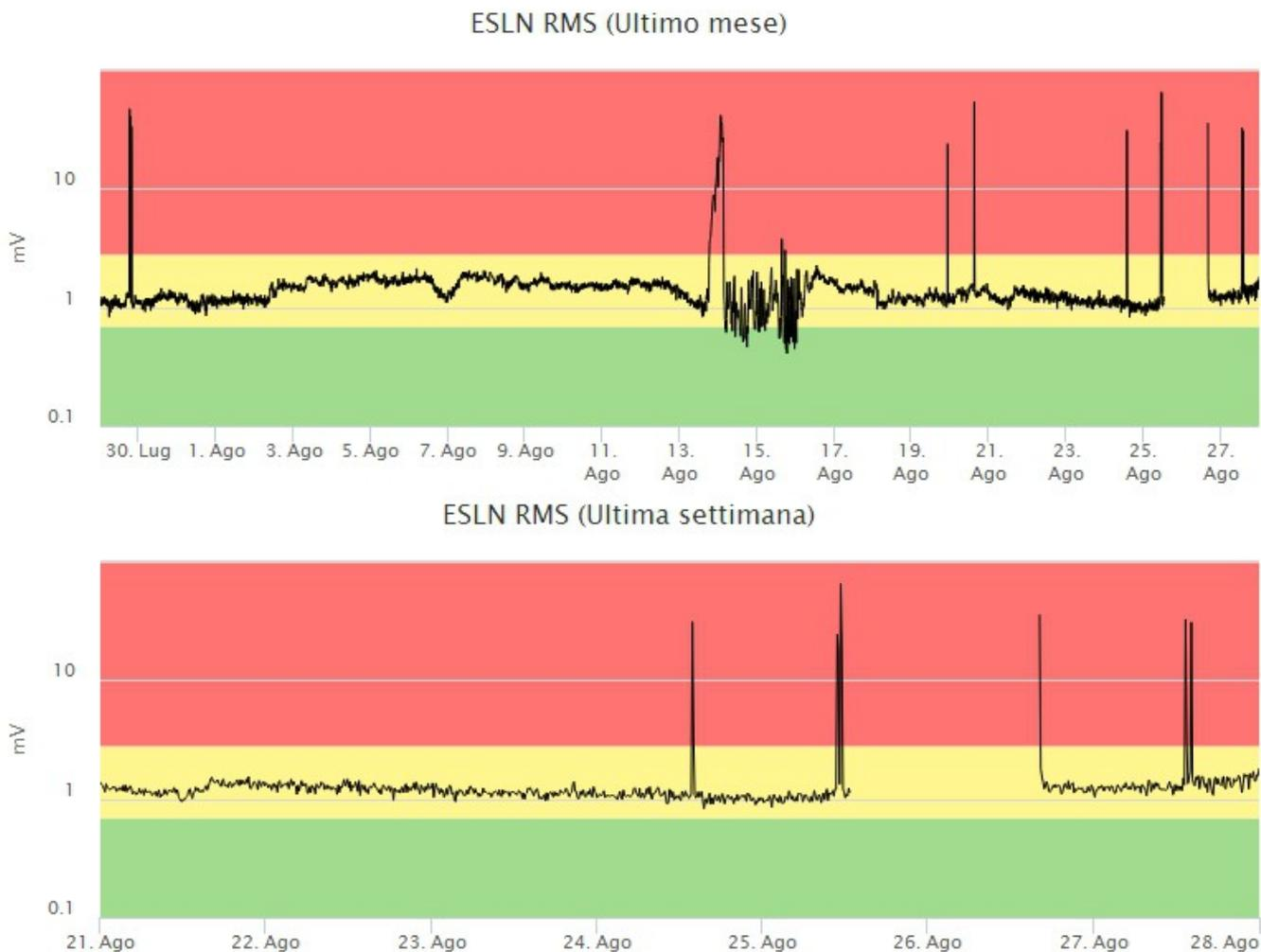
**Fig. 4.3** Andamento temporale dell'ampiezza media del tremore vulcanico: valori RMS nell'ultimo mese (in alto) e nell'ultima settimana (in basso) secondo tre livelli di ampiezza (basso=verde, medio=giallo, alto=rosso).
